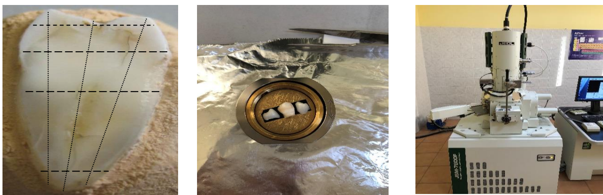
Рисунок 1 – Фрагмент шлифа постоянного интактного моляра со схемой изучения конкретных точек измерения микротвердости тканей зуба. Аппарат для определения микротвердости по методу Виккерса.
