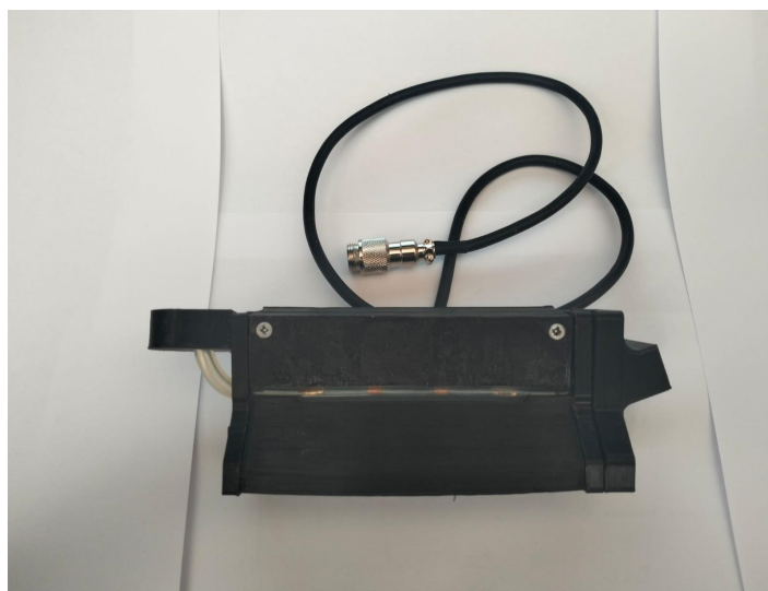
Рисунок 5 – Датчик джоульметрического измерительного комплекса
