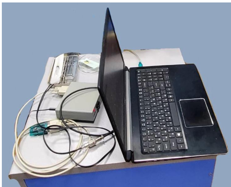
Рисунок 4 – Джоульметрический измерительный комплекс для неинвазивной экспресс-диагностики воспаления тканей периодонта
